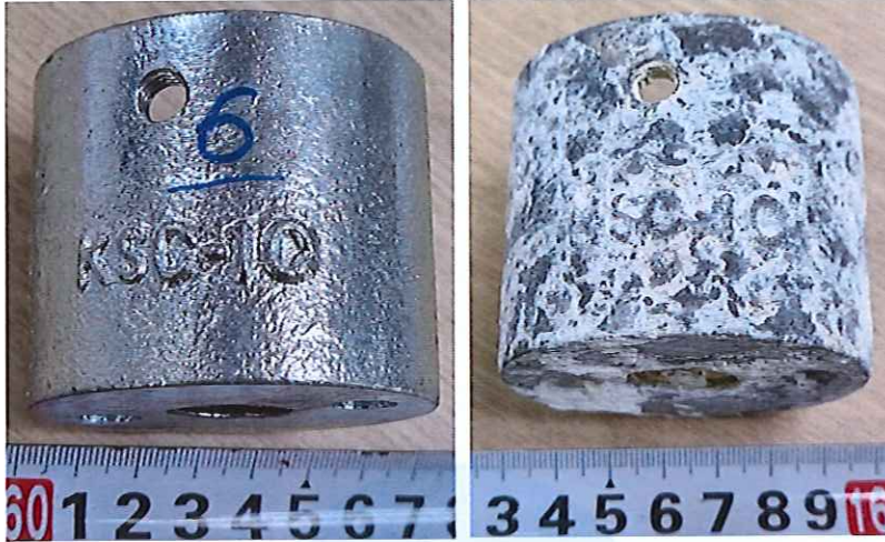
Trước khi thử phun sương muối Sau khi thử phun sương muối 240h
